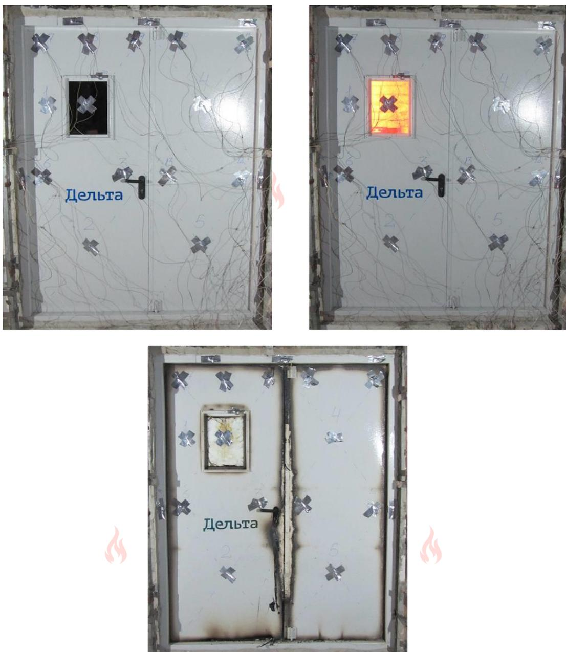
Рисунок 11 – Вид опытного образца №1 до, в процессе и после испытаний.
